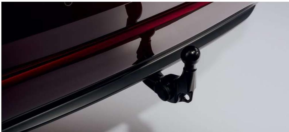
ATTELAGE RÉTRACTABLE - SEMI ÉLECTRIQUE
