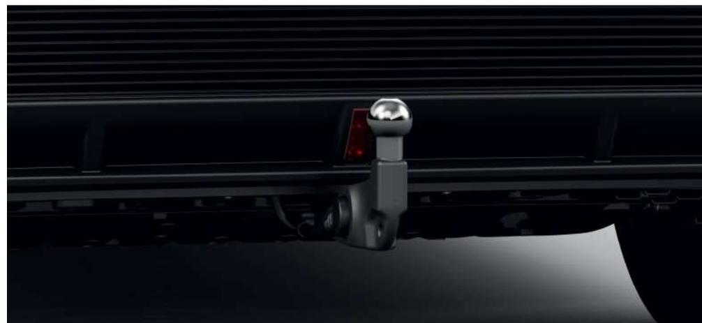
ATTELAGE RÉTRACTABLE, ÉLECTRIQUE, AVEC FAISCEAU D'ATTELAGE
